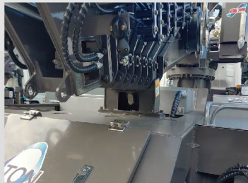
붐 자동 격납 시스템(자동 원점 복귀 시스템)
