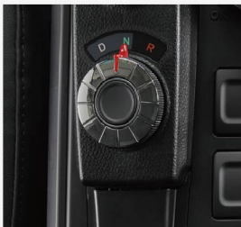
자동 변속기 컨트롤러
